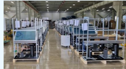
냉난방기 조립반, B동
